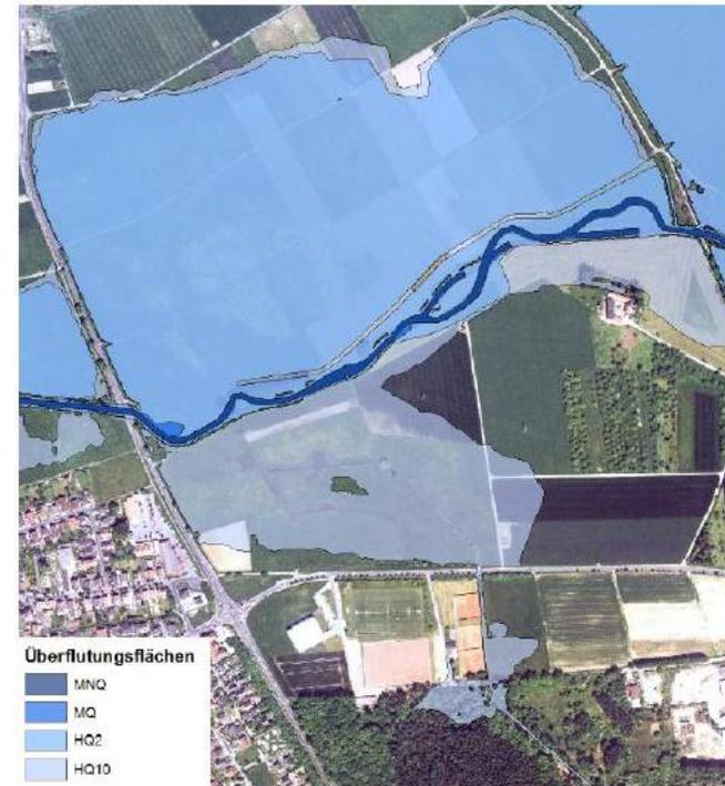
Abbildung 3: Überflutungsflächen des Plan-Zustands
