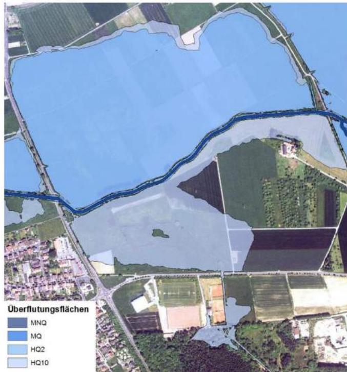
Abbildung 2: Überflutungsflächen des Ist-Zustands
