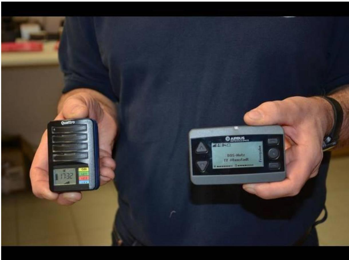
links: der seitherige analoge Meldeempfänger; rechts: der neue digitale Meldeempfänger
