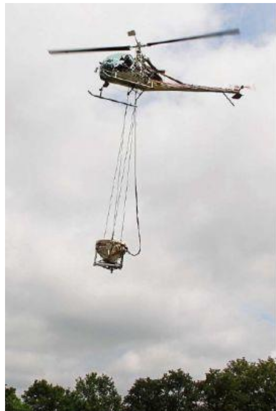
Sieben Tonnen Granulat mit dem für die Larven tödlichen Wirkstoff BTI verstreut der Hubschrauber entlang der Nidder.
